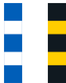
I10.1-2 Liikennemerkkipylvään tehostamismerkki
