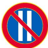
C44.1 Vuoropysäköinti (kielletty parillisina päivinä)
