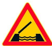
A6 Avattava silta
