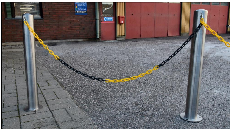
Rosteripollarit ovat kokoa 102x1200mm, pyöreillä kiinnityslaiipoilla, 30mm korvakkeilla ja kelta-mustalla teräsketjuilla.
